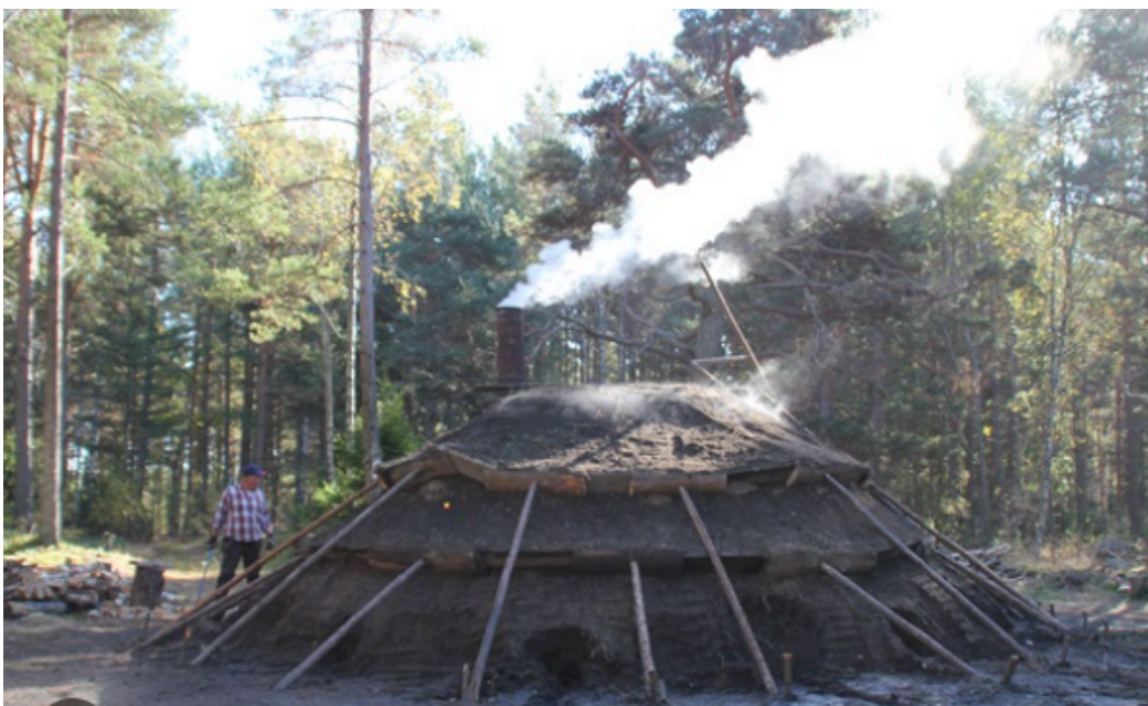
En traditionell kolmila som visar ett sätt att skapa biokol (träkol).
